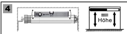
**i** Montieren Sie das Motorlager so, dass die Schrauben für die Endlageneinstellung am Motorkopf später gut zugänglich sind und das Motorkabel ohne Knick nach unten hin verlegt werden kann.
