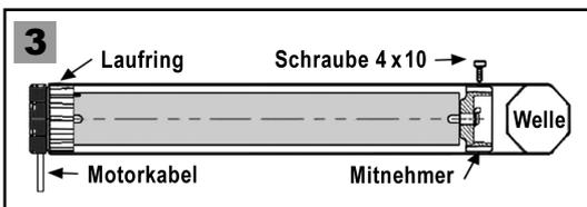
**Einbau des Rohrmotors in die Wickelwelle** (Abb. 3)
